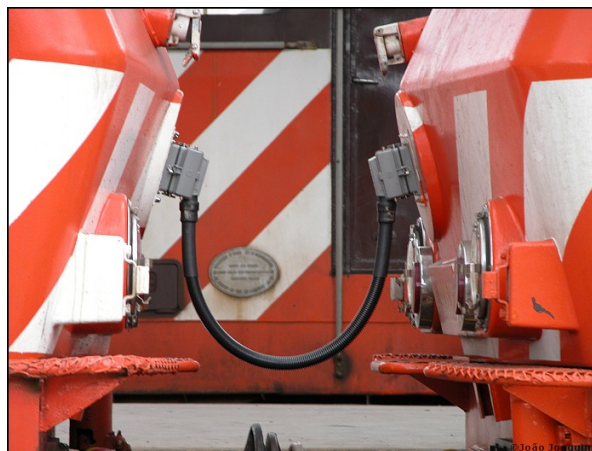
Cabo de ligação de UM entre as locomotivas 2602 e 2605, parquedadas na Pampilhosa
