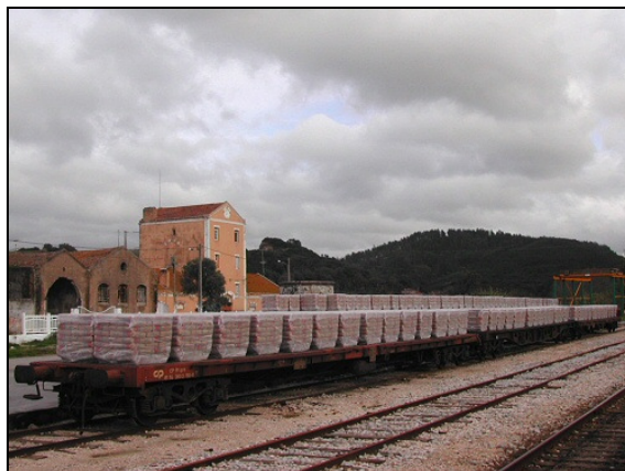
Vagões Rips com paletes de cimento em saco aguardando descarga
